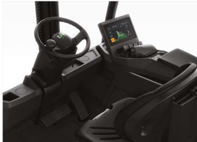
Ergonomisch gestaltete Fahrerkabine mit neuer Armlehne und Handballenauflage für optimalen Fahrerkomfort.
