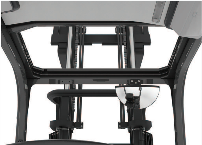
Freie Sicht auf die Gabelspitzen durch alle Hubgerüste, transparentes Glasdach (optional) ermöglicht sichere und effiziente Umschlagarbeiten und erhöht den Komfort und die Produktivität des Fahrers.
