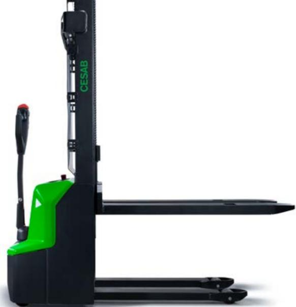
El **CESAB S010i** tiene un diseño de cuatro ruedas y ofrece la máxima estabilidad, con alturas de elevación de hasta 3,6 metros
